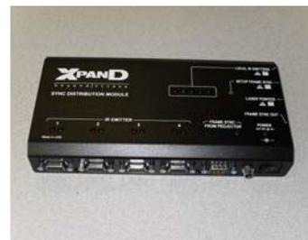
Для сохранения мощности и продления срока службы, распределительный модуль активирует инфракрасные эмиттеры, только если синхронизирующий сигнал находится на частотах между 36 Гц и 80 Гц. Фильмы в 3D работают на частотах между 48 Гц и 72 Гц, тогда как фильмы в 2D работают на частоте в 24 Гц. По этой причине нет необходимости выключать устройство при показе фильма в 2D или при выключении проектора.
